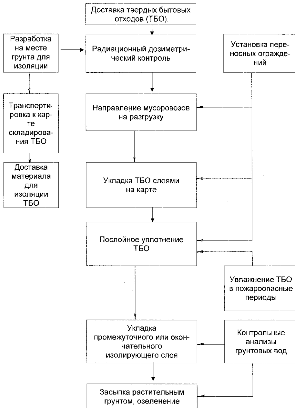
Рисунок 1 – Основные технологические операции при эксплуатации полигона
