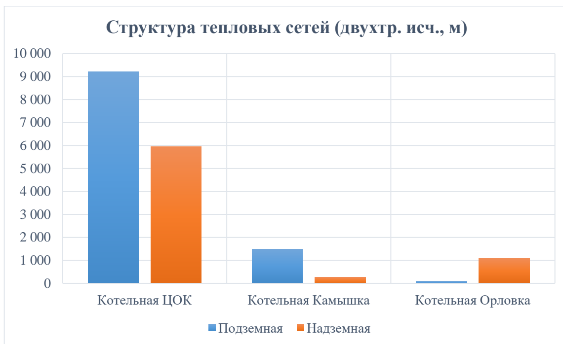
Рисунок 3.1 – Структура тепловых сетей по видам прокладки
