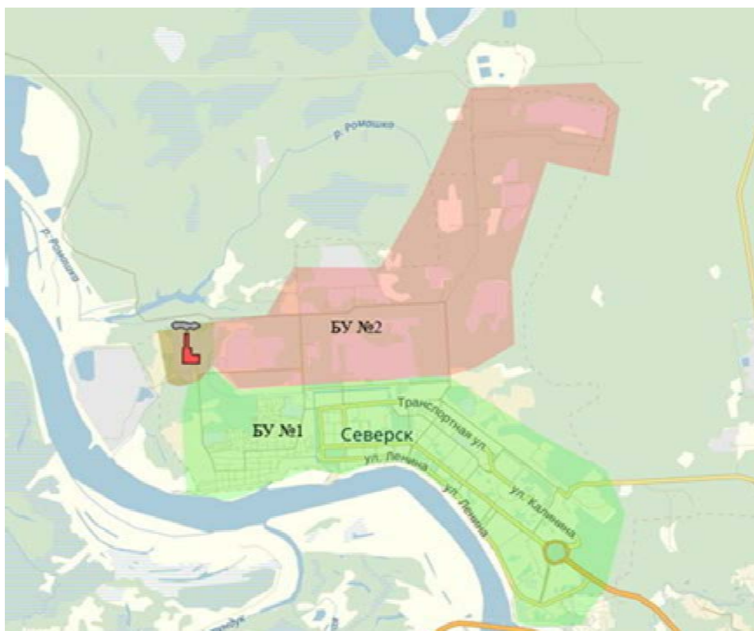
Рисунок 4.1 – Существующая зона действия ТЭЦ АО «РИР» (потребители, получающие тепловую энергию от бойлерной установки № 1 - отмечены зеленым цветом; потребители получающие тепловую энергию от бойлерной установки № 2 отмечены красным цветом)
