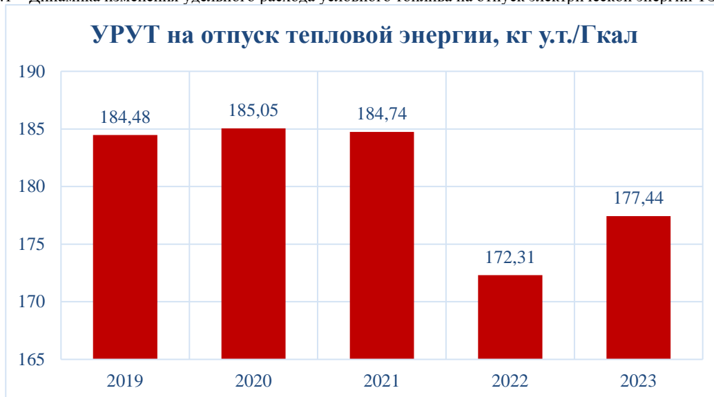
Рисунок 10.1 – Динамика изменения удельного расхода условного топлива на отпуск электрической энергии ТЭЦ АО «РИР»
