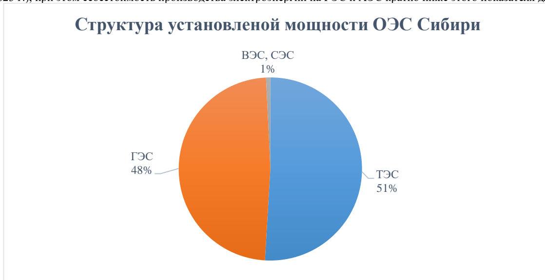
Рисунок 3 – Структура установленной мощности электростанций ОЭС Сибири
