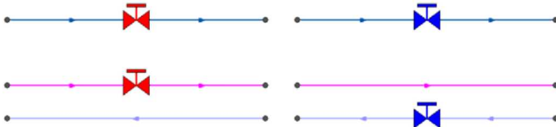
Рисунок 13 – Однолинейное изображение (вверху) и внутреннее представление (внизу) сети с регуляторами давления
