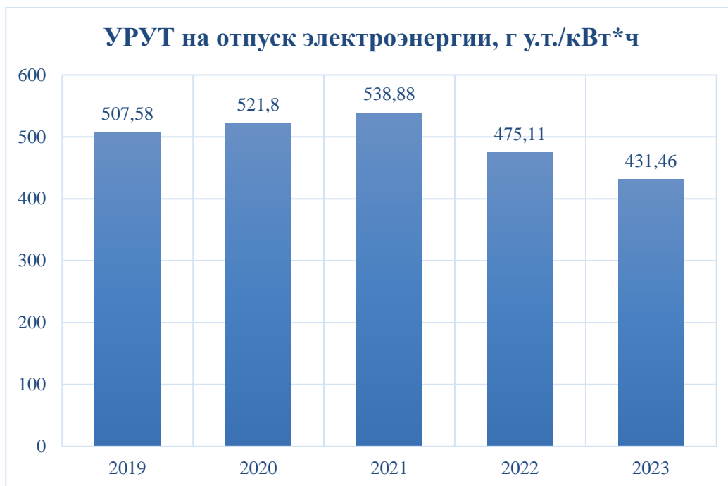
Рисунок 10.1 – Динамика изменения удельного расхода условного топлива на отпуск электрической энергии ТЭЦ АО «РИР»
